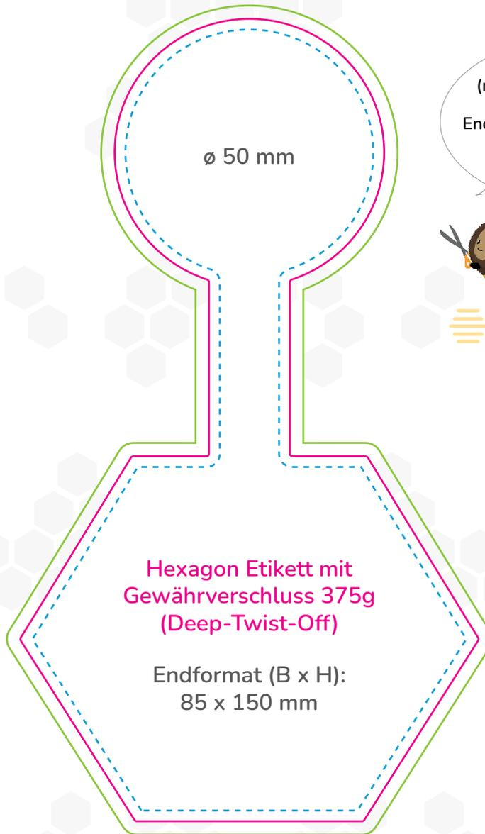
Entlang der **Stanze** (mittlere Linie) ausschneiden und das ausgeschnittene Endformat an deinem Honigglas testen. Passt das Format? Prima! Dann leg los mit deinem Design!
